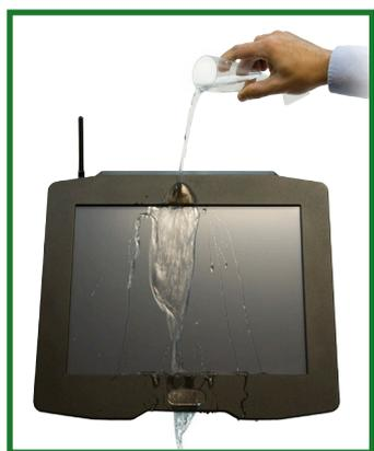
Test de resistencia al agua IP66
